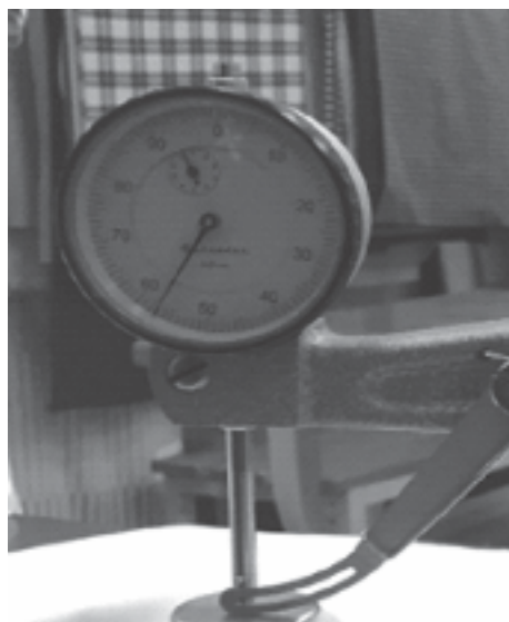
Hình 1. Hình ảnh đo thiết bị độ dày của vải.
